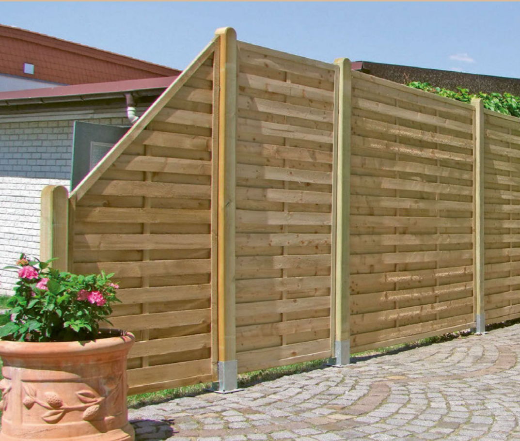
Lamellenzaun Pisa Rahmenteile 3,0 x 5,0 cm gehobelt, Lamellen 0,24 x 7,7 cm, feingesägt, kesseldruckimprägniert
