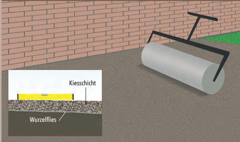
Bei der Planung Ihrer Terrasse sollten Sie den Sonnenverlauf und die vorrangige Windrichtung beachten. Stehen Standort und Grundfläche fest, gilt es, das benötigte Material zu berechnen und den Boden vorzubereiten. Nach der Abtragung des Mutterbodens ist es sinnvoll, ein Wurzelflies zu verlegen und die Fläche mit einer 5 cm starken Kiesschicht zu befüllen und zu verdichten. Hierbei sollte ein Gefälle von ca. 2 cm / 1 m in Wasserablafrichtung geschaffen werden.
