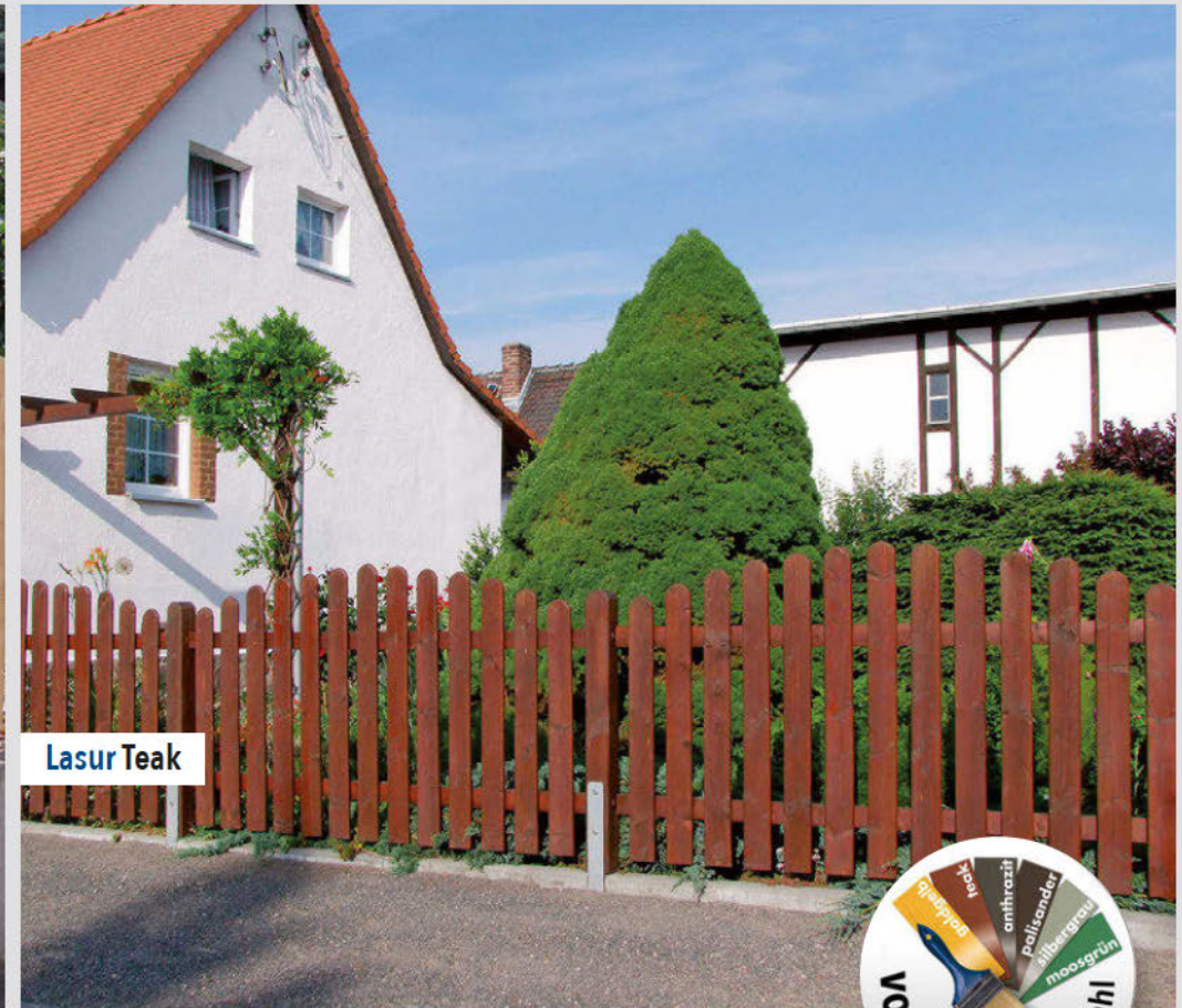
Staketenzaun Föhr geschwungen Bretter 2,0 x 9,5 cm gehobelt, verzinkt genagelt, Kanten gefast, Kopf gerundet, kesseldruckimprägniert 13 Staketen pro 180'er Feld
