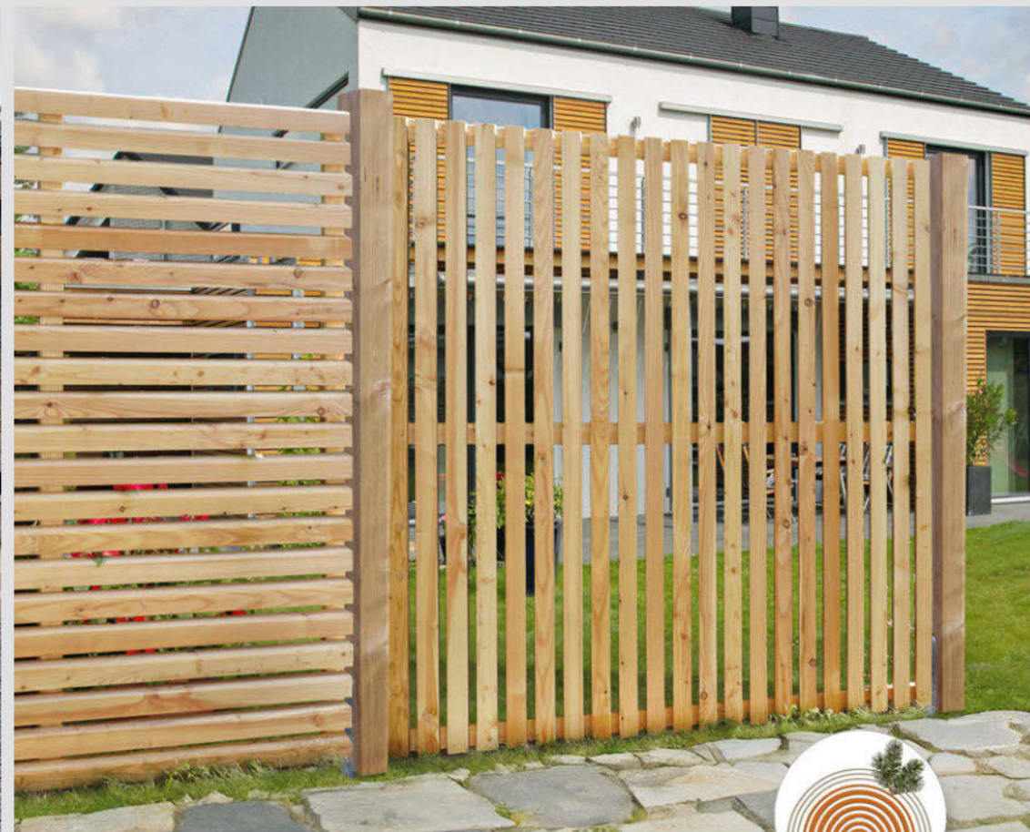
Rhombuszaun Malmö: aus Rhombusprofil Douglasie, 2,8 x 6,8 x 180cm, glatt gehobelt, roh, Riegel: 2,5 x 6,5cm
