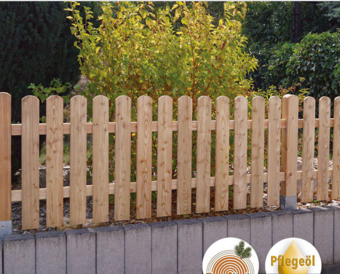
Staketenzaun Föhr aus Douglasie Bretter 2,0 x 9,5 cm gehobelt, verzinkt genagelt, Kanten gefast, Kopf gerundet
