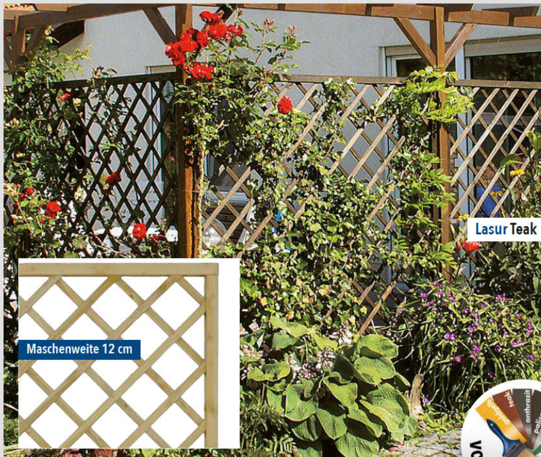
Rankgitter Meran Rahmenteile 4,3 x 4,3 cm gehobelt, Ecken gezapft, Streben 1,2 x 3,0 cm, gehobelt und abgerundet, Maschenweite 12 cm, kesseldruckimprägniert
