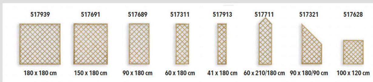
Rankgitter Meran Rahmenteile 4,3 x 4,3 cm gehobelt, Ecken gezapft, Streben 1,2 x 3,0 cm, gehobelt und abgerundet, Maschenweite 12 cm, kesseldruckimprägniert
